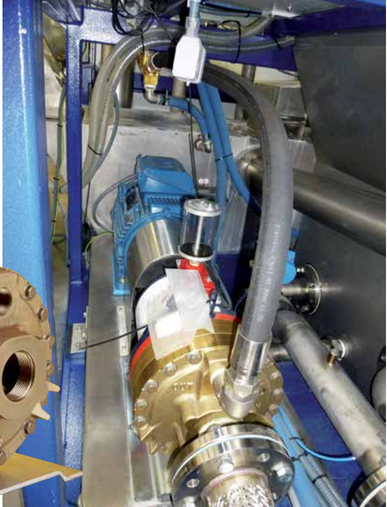
La pompa Hydra-Cell G35 ad alta pressione sul modulo lavaggio blocco motore di MecWash (a destra). Sotto, la pompa Hydra-Cell G35
