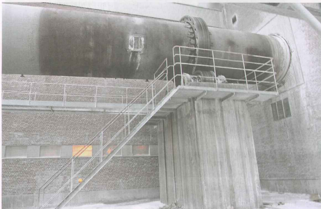
Sedan flera år eldas mesaugnarna hos Smurfit Kappa med träpulver. Normalt används fossilolja som bränsle i mesaugnar.
